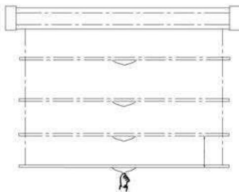
重要：格納するときは、常に生地を 90 度の角度で引き下げてください。画面が動かなくなったと感じた場合は、画面のメカニズムが新しく、緩めるために数回上下に動かす必要があることに注意してください。これが発生した場合は、慎重に、少し力を入れて、画面をまっすぐ下に引っ張ってメカニズムのロックを解除します。
