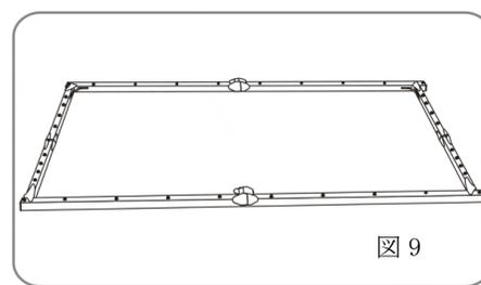
4. フレーム (A) の左右の底部にある開口にスタンド (B) を差し込み、ノブネジで固定
