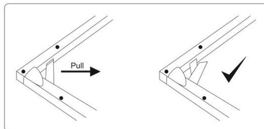
8. 折り畳みジョイントの近くにシルバーのロックボタンを押し、折り畳みフレームの両側をゆっくりと折り畳む
