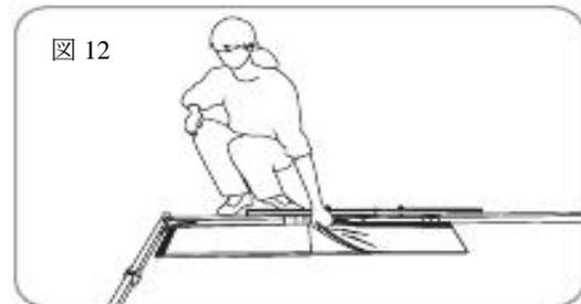
6. スクリーン生地 (D) が完全に伸ばしたら、図 13-15 に示すように、ボタンをフレームに固定
