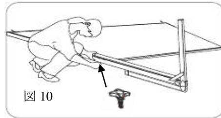
5. スクリーン生地 (D) をキャリングケース (C) から取り出し、スクリーン生地のコーナーをフレームの内側コーナーに合わせます。図のように展開 (図 11-12)。
