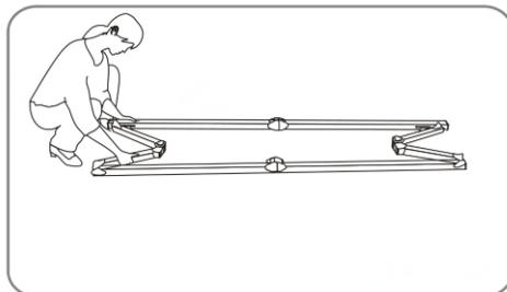
9. フレームのあるシルバーのロックボタンを押し、折りたたみみ枠の一端を持ち上げて、畳みます。長い方の部分は2回折りたたみます
